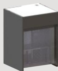
As Cabines de Pesagem REINTECH, foram desenvolvidas para a maior segurança e eficiência do processo de pesagem de matérias primas e similares. Com sua técnica única de "plenum" despressurizado, através de Unidades Filtro Ventilador - UFV's. Formam conjunto único caracterizado por Fluxo de Ar de Proteção - Unidirecional com despressurização da área de trabalho. Total respeito ao conceitos definidos pelas Boas Práticas de Fabricação BPF's.
